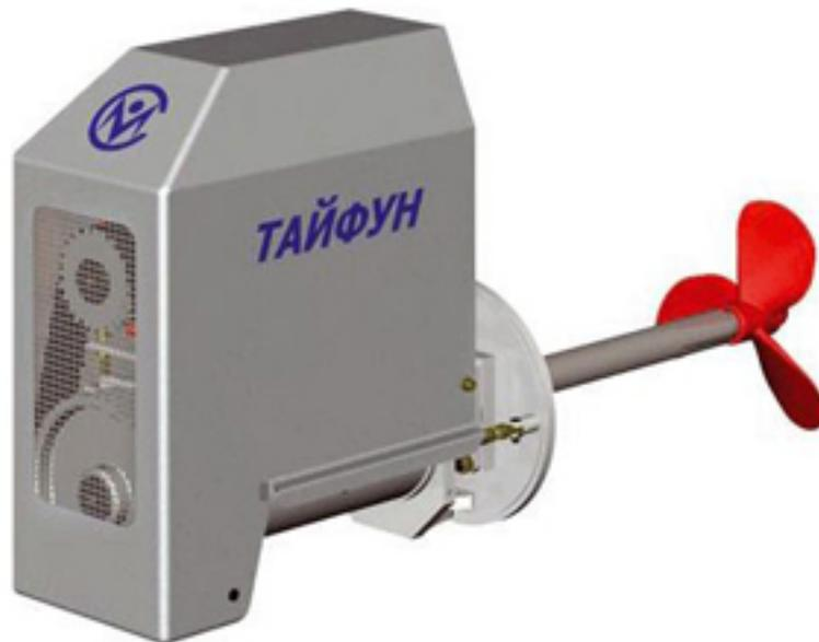
Устройство «Тайфун» предназначается для установки на нижней части резервуаров с нефтью и нефтепродуктами на крышке овального или круглого люков; эксплуатируется во взрывоопасных зонах класса В-1а. Устройство обеспечивает быстрый размыв донных отложений. Конструкция рассчитана на работу в жидкостях вязкостью до 40 сСт.
