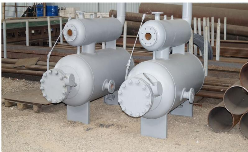
Ёмкость сепарационная предназначена для разделения с применением центробежного и гравитационного методов жидкой и газовой фаз продукции скважин, поступающей на вход емкости (сырой нефти и попутного нефтяного газа), частичного отделения растворенного в жидкости газа для измерений.
