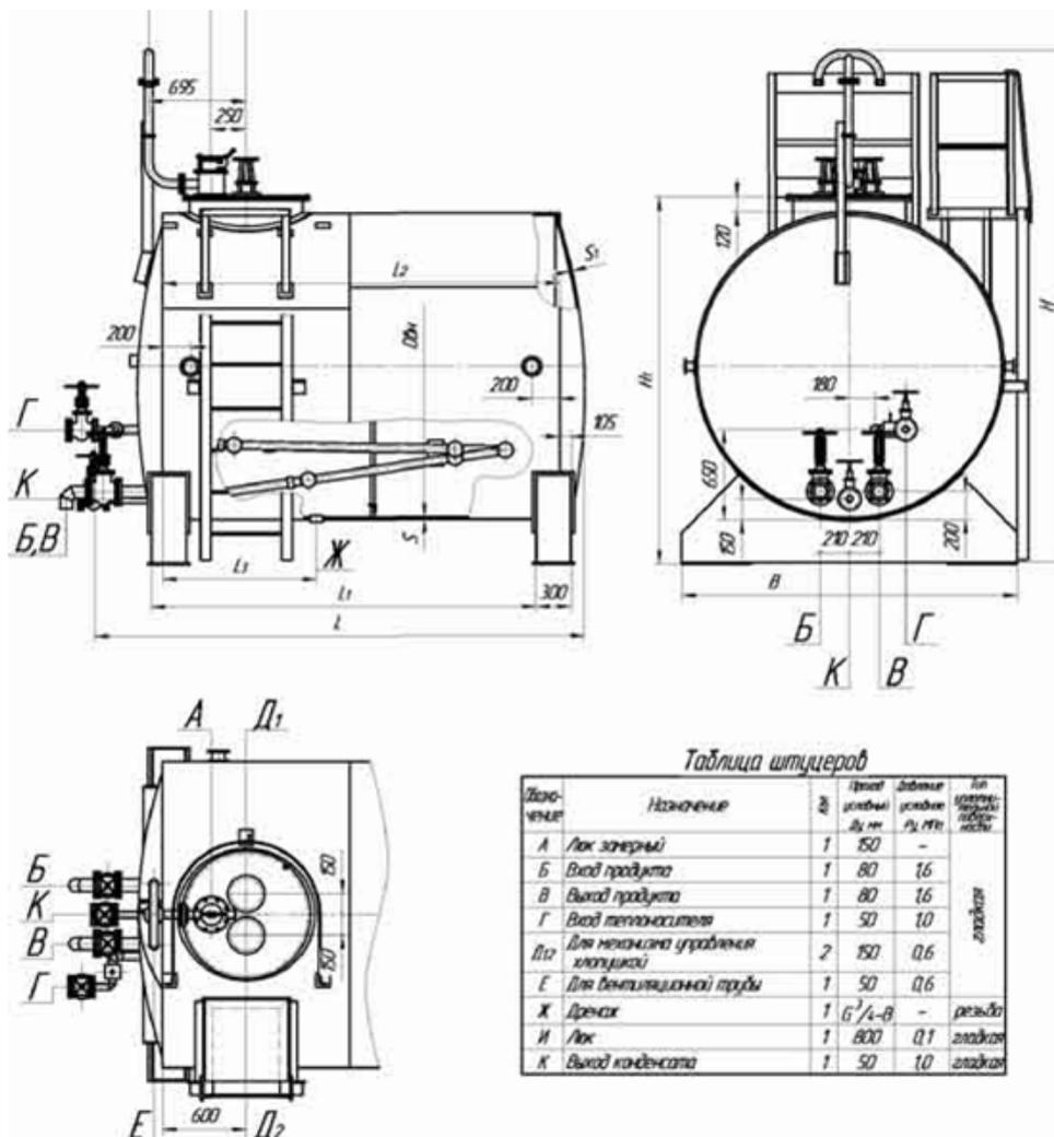
Резервуары горизонтальные стальные наземные цилиндрические РГС-100 (с плотностью хранимого продукта не более 1 т/м<sup>3</sup>) предназначены для приёма, хранения, выдачи:
