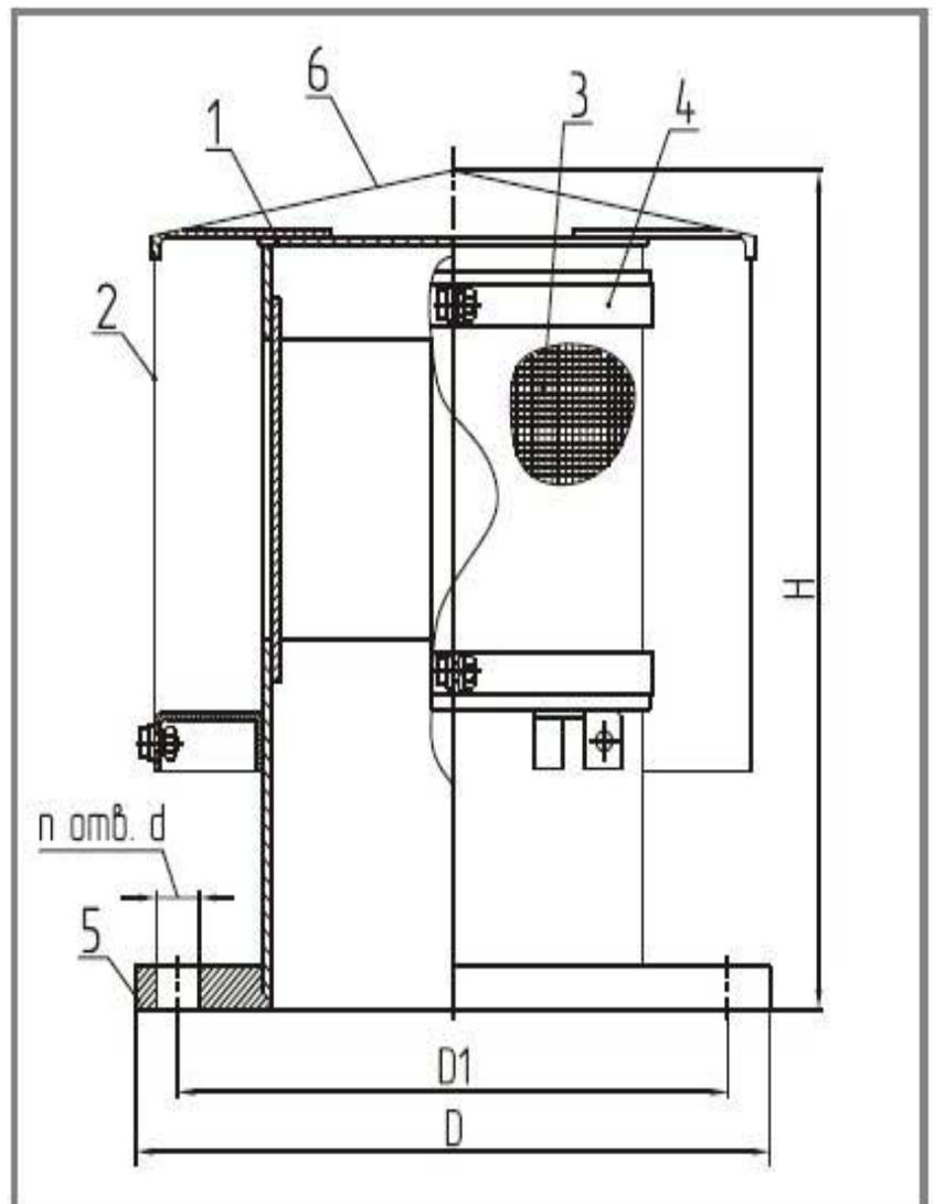
Общий вид патрубка вентиляционного ПВ
