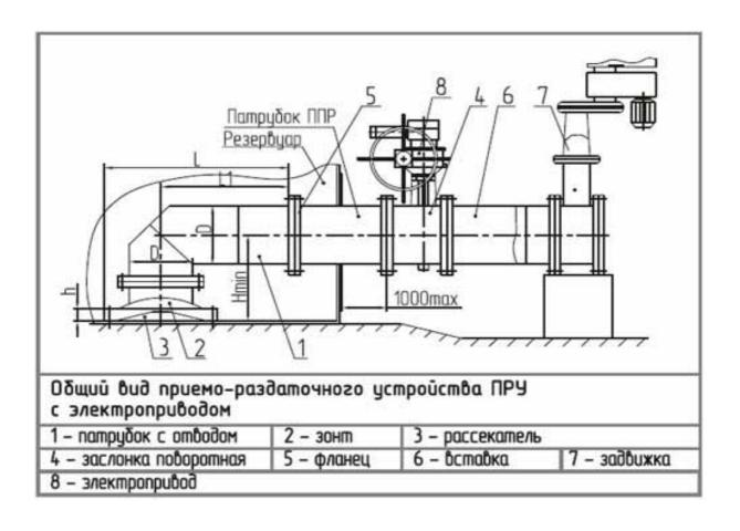
В состав устройства входят два приёмо-раздаточных патрубка с отводами 1, зонтами 2, рассекателями 3, поворотными заслонками 4, а также электрическими приводами 8.
