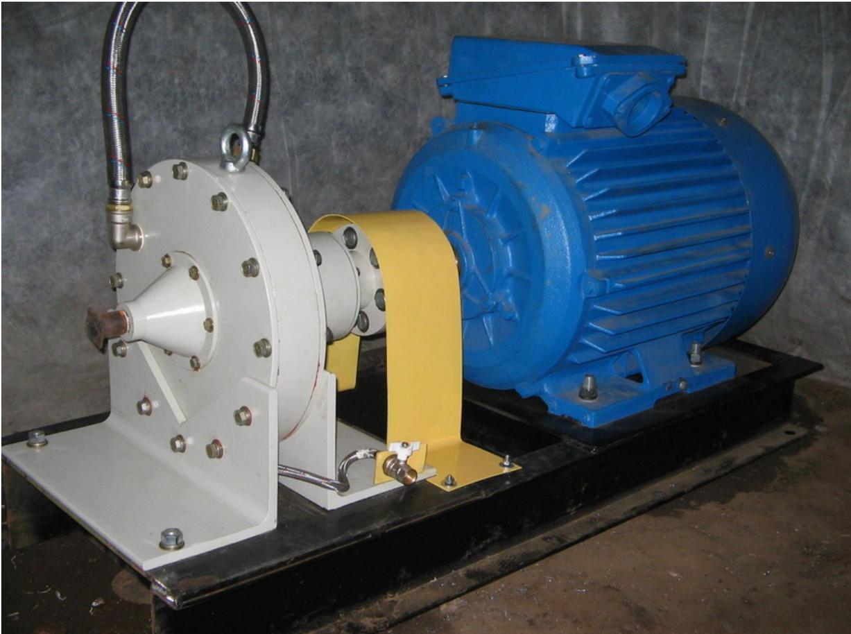
Парогенераторы ПГМ – это инновационное поколение установок для получения пара. Нагрев воды в этом устройстве осуществляется за счет воздействия трёх видов: механического, гидродинамического, гидроакустического.
