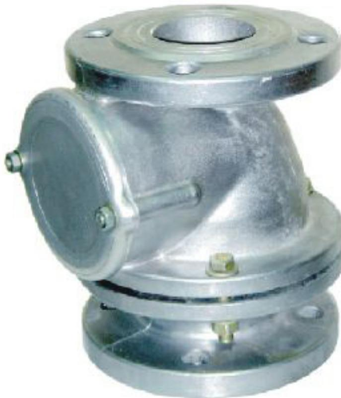
Пример обозначения при заказе: КДЗТ-50 (А) У1 ТУ 3689-015-00217633-97 (где «КДЗТ» – клапан дыхательный закрытого типа, «50» – условный проход клапана, «(А)» – алюминиевый корпус, «У1» – климатическое исполнение).
