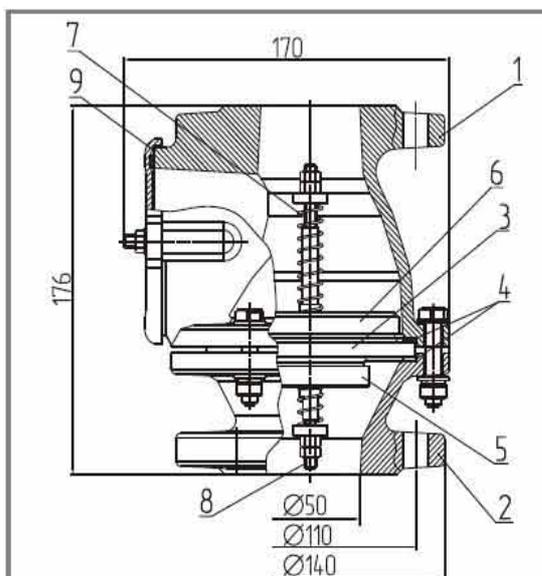
Общий вид клапана дыхательного закрытого типа КДЗТ-50А
