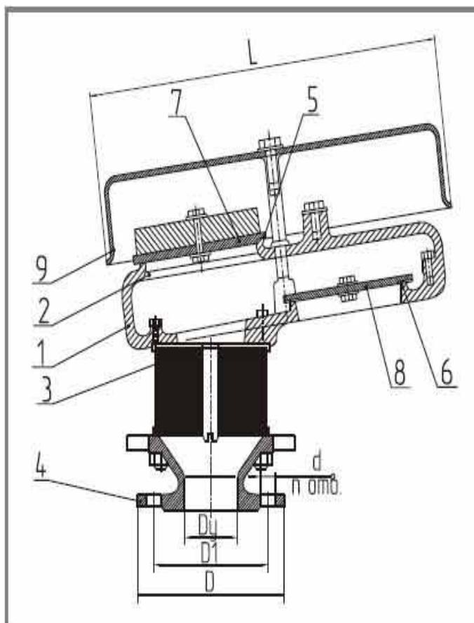
Общий вид клапана дыхательного механического КДМ-50
