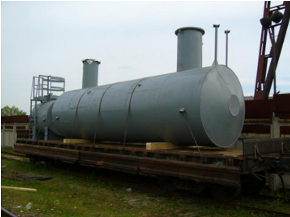
Ёмкости подземные ЕП 8 – это горизонтальные цилиндрические аппараты, предназначенные для установки в грунт, имеющие 2 люка и штуцеры для технологических процессов КИПиА. На одном из люков располагается электронасосный агрегат. Рабочая среда является слабокоррозионной: скорость проникновения коррозии составляет не более 0,1 мм/год (при объёмном содержании H<sub>2</sub>S в газовой фазе не более 1,8 %).
