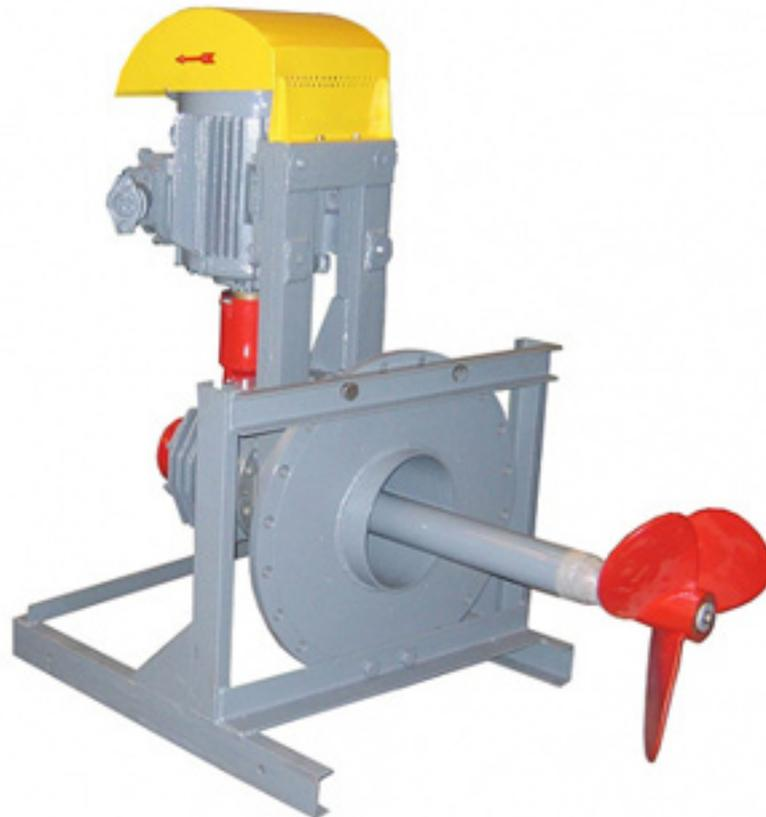
Поворотные мешалки с углом отклонения выходного вала  $\pm 30^\circ$ , электродвигателями 7,5; 11; 22 кВт и с двойным торцовым уплотнением выходного вала; используются для перемешивания ЛВЖ (бензин, дизельное топливо).
