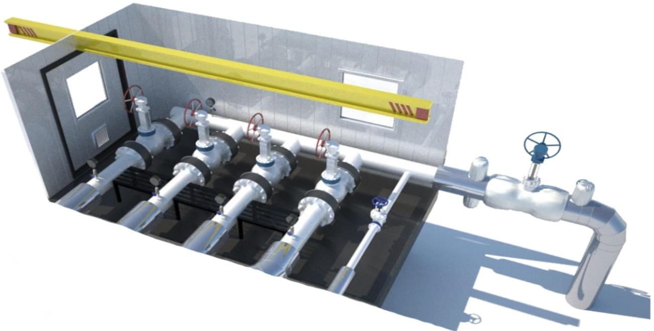
Блок напорной гребёнки (БГ) предназначен для распределения воды по нагнетательным скважинам системы поддержания пластового давления (ППД) и измерений тех параметров, которые соответствуют техническому заданию заказчика: расхода воды на каждую нагнетательную скважину; давления воды в указанных точках измерения; температуры воды в указанных точках измерения.
