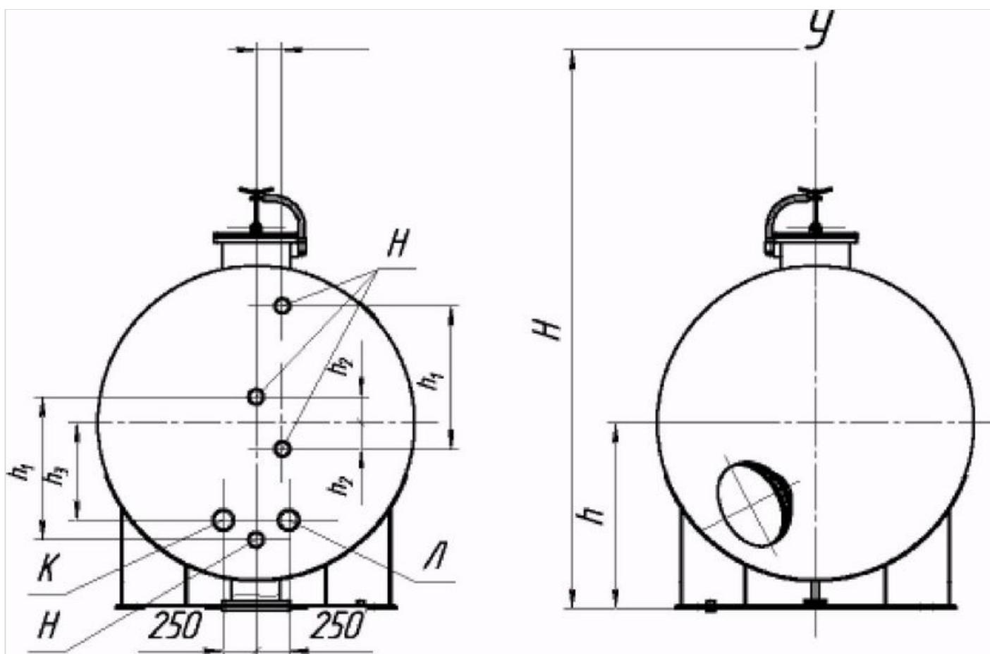
В случае установки на аппарате двух штуцеров «Н» их следует располагать на вертикальной оси днища.
