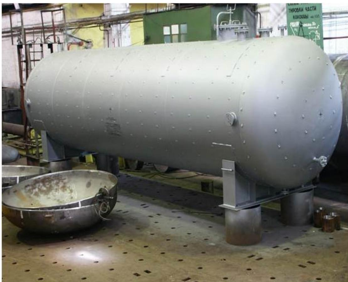
Предназначаются горизонтальные цельносварные аппараты с эллиптическими днищами, с трубным пучком типа ГЭЭ 1-2-V-р для приёма, хранения и выдачи газообразных и жидких сред при условном давлении в аппарате 0,6 МПа с постоянным или периодическим охлаждением (подогревом).
