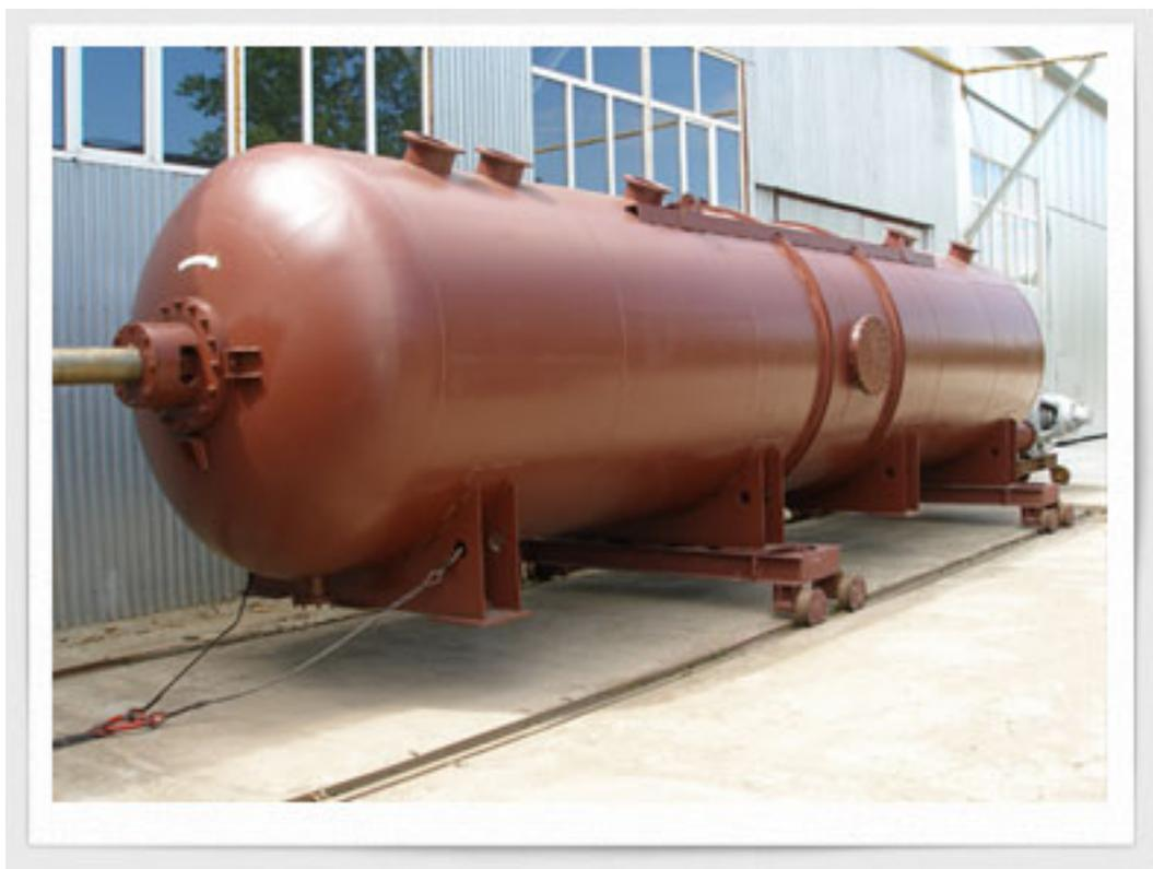
Предназначаются горизонтальные цельносварные аппараты с эллиптическими днищами типа ГЭЭ 1-1-V-р для приёма, хранения и выдачи газообразных и жидких сред при условном давлении в аппарате 0,6; 1,0 и 1,6 МПа. Осуществление выдачи жидких сред возможно как перекачиванием сжатым воздухом, инертным или технологическим газом, так и самотёком.
